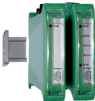
IL Trigger T-BOX-3M permette di realizzare un gruppo statico trifase AC-Switch con attivazione programmabile sia ZERO-CROSSING che ad ANGOLO DI FASE. E' composto da due unita connesse fra loro con flet (T-BOX-3M e T-BOX-3T) e montate sul supporto angolare a guida DIN in dotazione che permette l'applicazione al corpo dissipante composto dal semiconduttore ed eventuale fusibile e Snubber.
